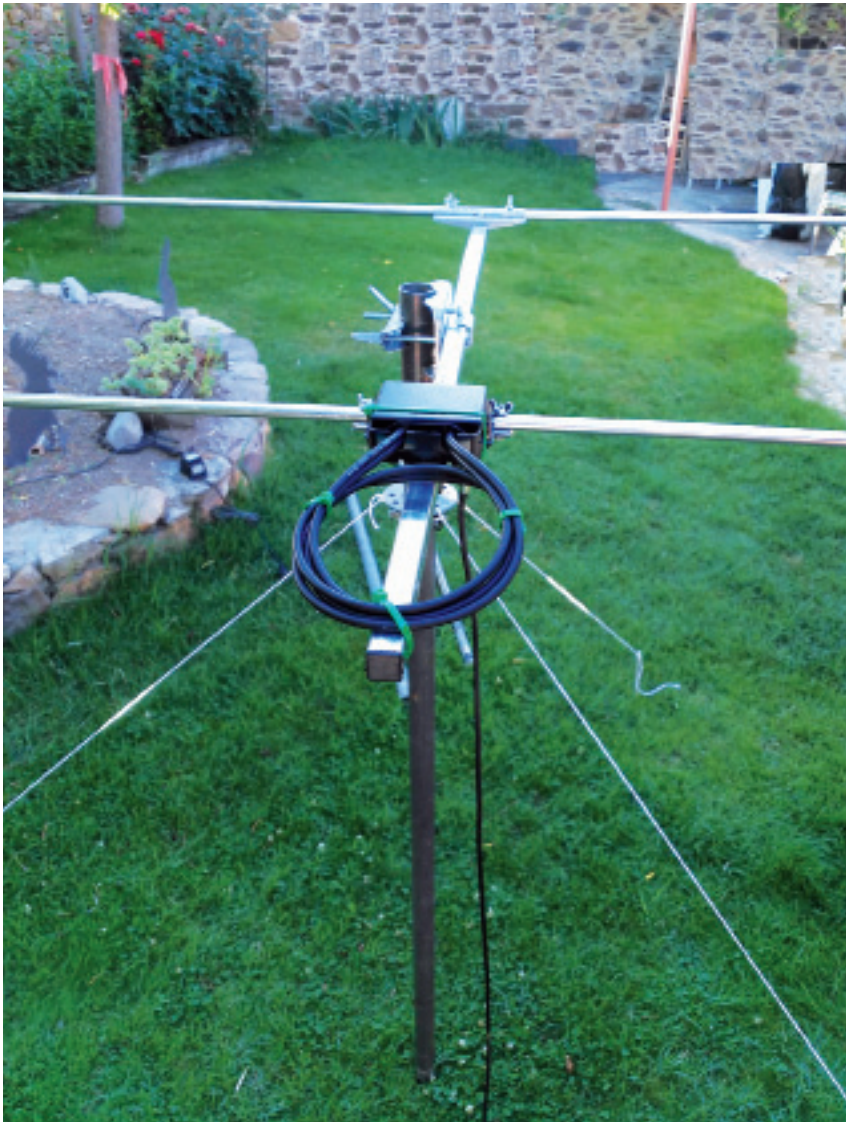
Imagen 5. Probando la antena con cable de TV todo de cobre
